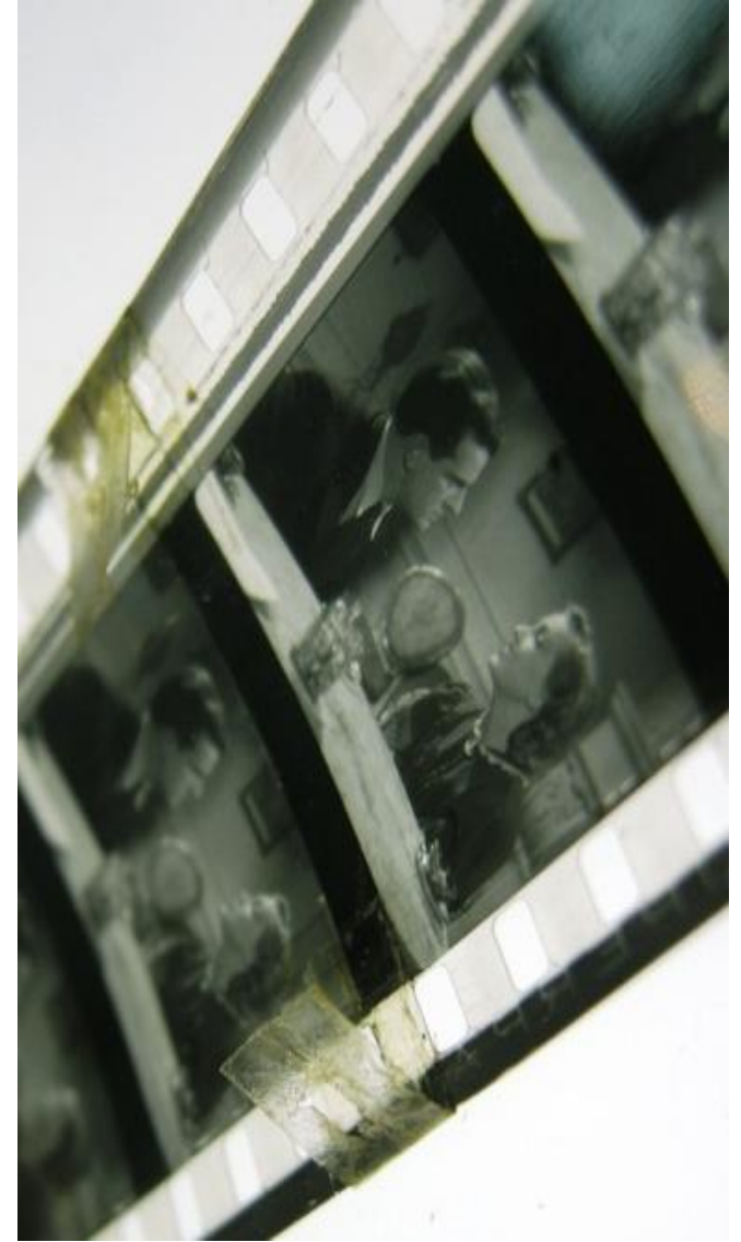
DEGRADACJA TAŚMY KLEJĄCEJ
