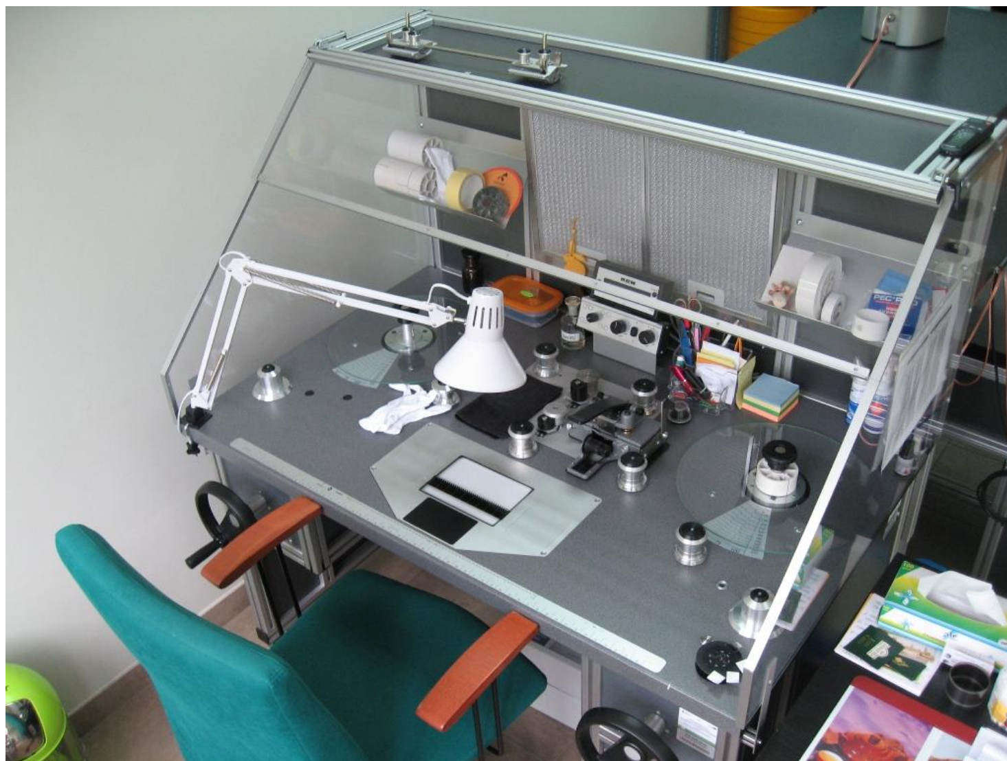
Stół mechaniczny (KEM) – konserwacja manualna taśmy filmowej
