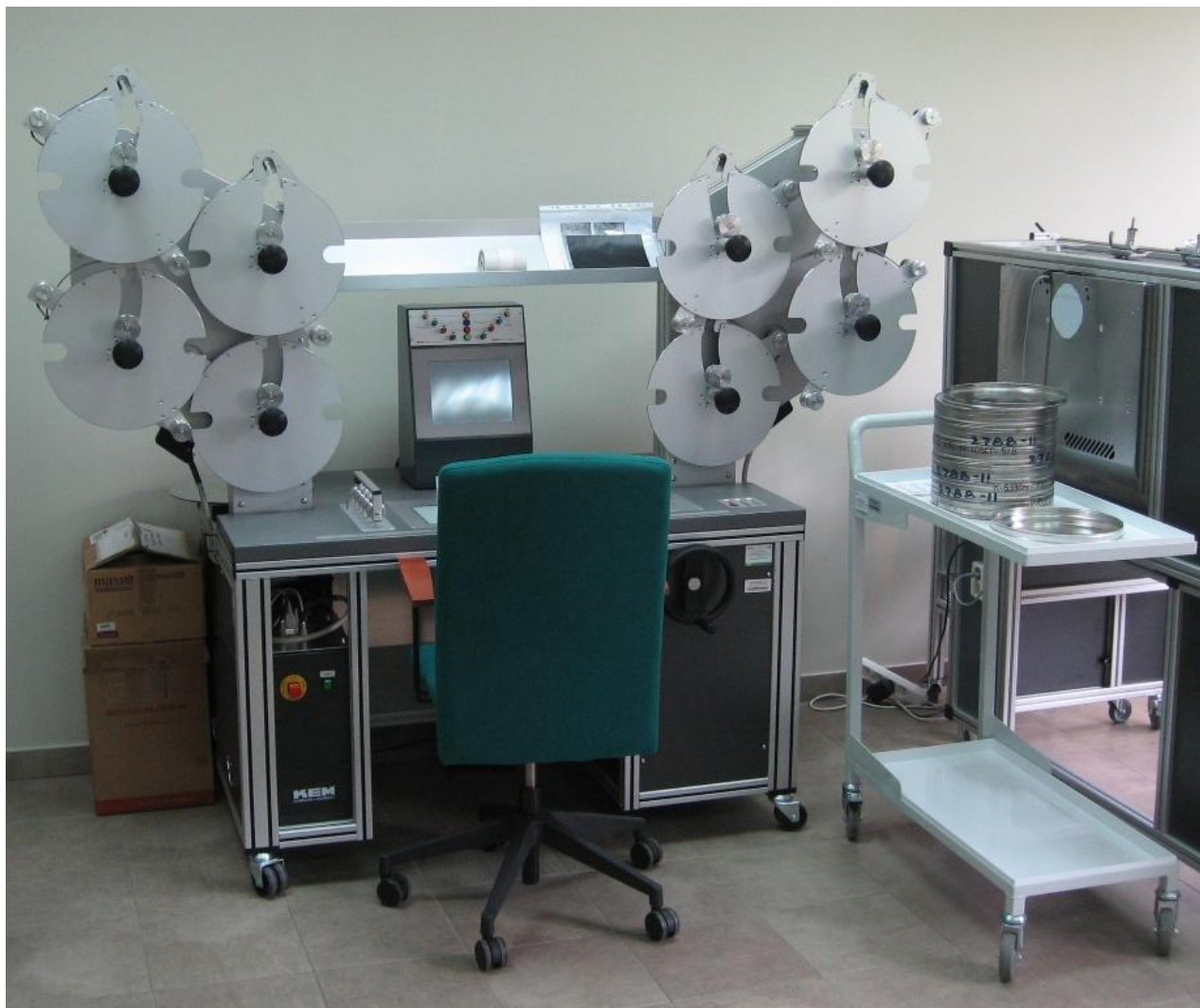
Stół synchronizacyjny (KEM) – konserwacja manualna taśmy filmowej
